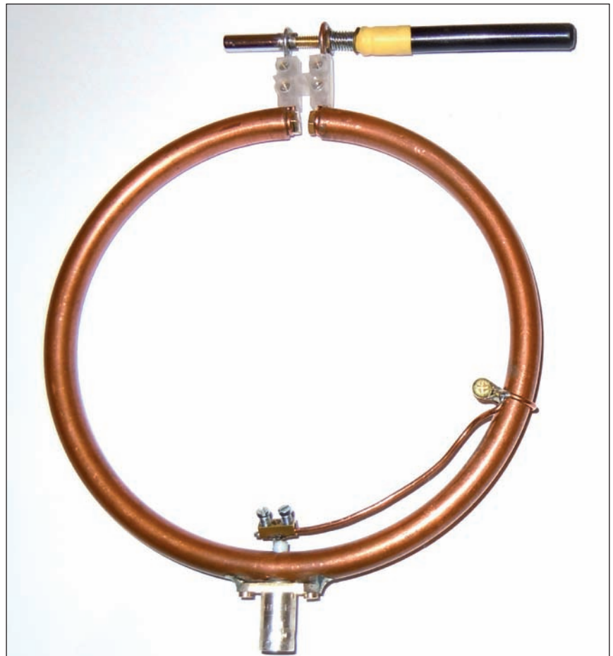
L'antenna a realizzazione ultimata
