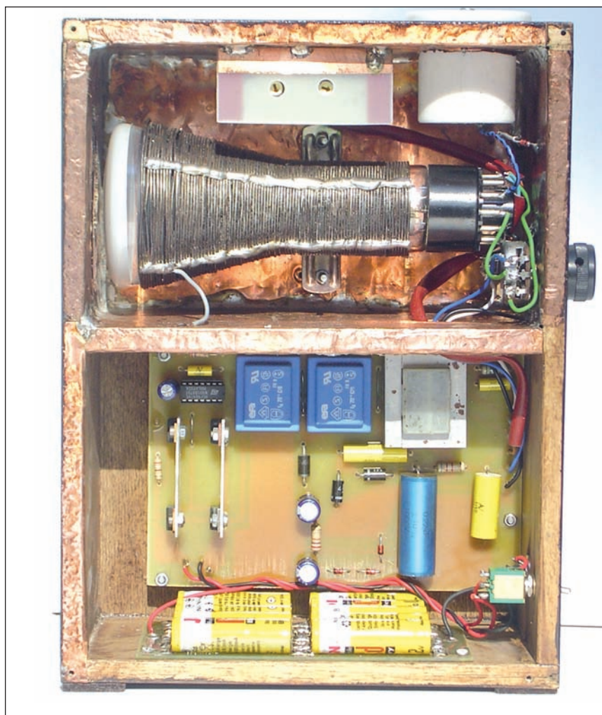
Fig. 2 - Vista interna dell'elettroscopio. Si nota la schermatura del tubo catodico, realizzata con filo di ferro dolce avvolto a spirale in modo da seguirne la sagoma: si può usare anche un tubo di ferro di adatto diametro.
