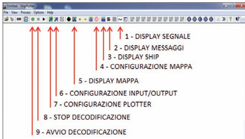
Fig. 2 - I comandi principali di SHIP PLOTTER
