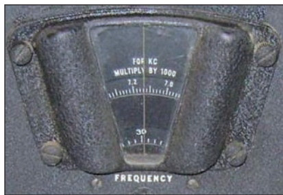
Scala del BC-312. Da 7.000 a 7.100 kHz in cinque tacche. Rispetto a un casalingo va molto meglio.
