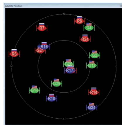
Fig. 5 - Posizione dei satelliti rispetto al ricevitore nel piano azimutale
