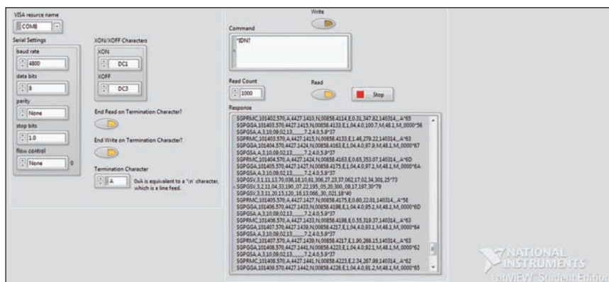
Fig. 2 - Il pannello di controllo del programma in LabVIEW per l'acquisizione dei dati NMEA
