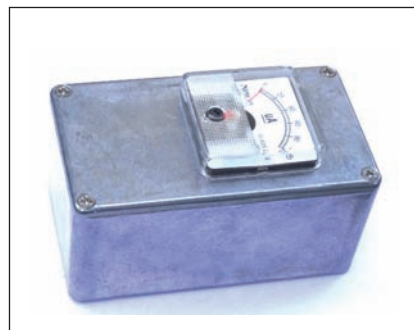
Fig. 3 - Strumento completo di box schermato in Al
