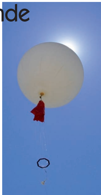
Fig. 1 - Foto di un pallone con relativa radiosonda
