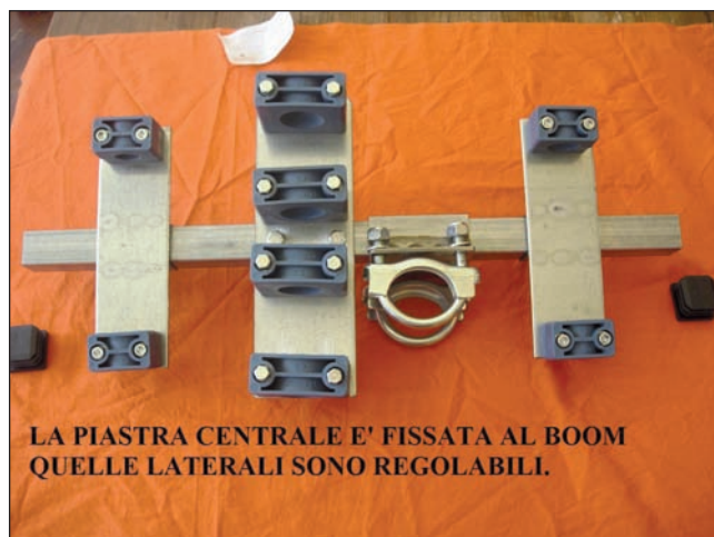
PIASTRA DIPOLO CENTRALE ACCIAIO ZINCATO CM 8 X20 CON RELATIVI FORI
