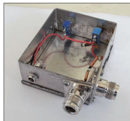
Fig. 8 - Notare la disposizione ad angolo dei due connettori N
