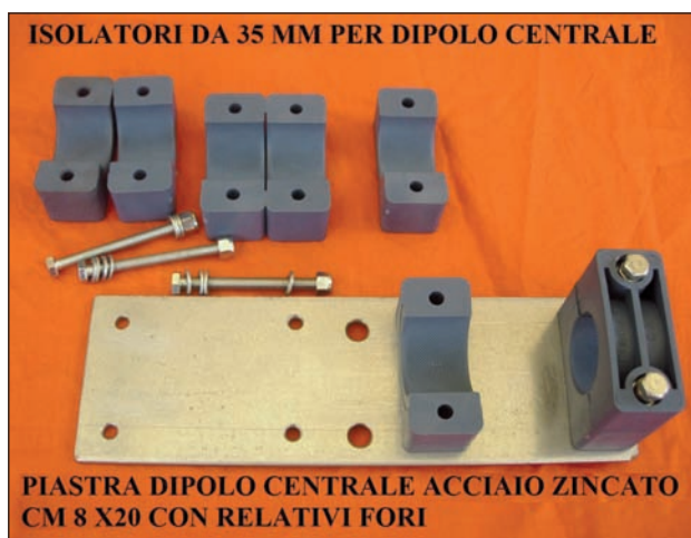
LA PIASTRA CENTRALE E' FISSATA AL BOOM QUELLE LATERALI SONO REGOLABILI.
