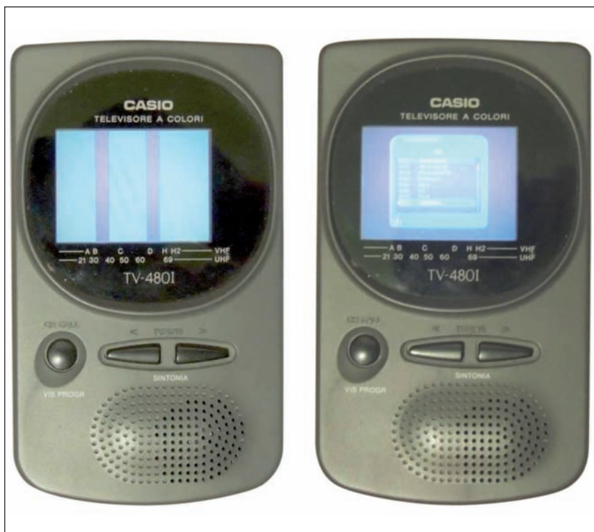
Il TVC LCD portatile da 2" della CASIO mod.TV480I utilizzato nelle prove di ricezione. A sinistra il display mostra il segnale di TEST, a destra l'elenco dei programmi televisivi provenienti da un decoder DTV.
