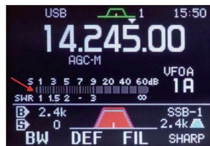
Schermo dell'IC-7000 dell'autore. La freccia rossa mostra l'indicatore a barrette dello S-meter, senza segnale. Sopra S 9 si vede una barretta ogni 10 dB. L'apparato rileva variazioni molto minori, visibili con un PC, l'apposita interfaccia e un software adatto.
