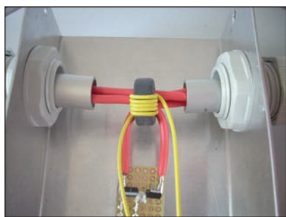
Particolare della ferrite interna con le spire di prelievo segnale e dei diodi varicap
