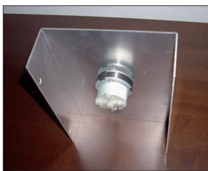
Vista del motore da dentro la base dell'antenna
