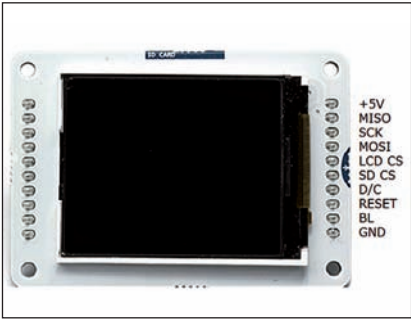
Fig. 3 - Vista frontale del modulo TFT. A destra la descrizione dei pin
