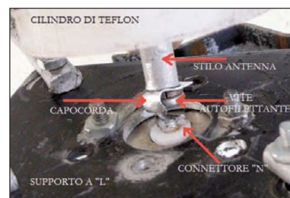
Fig. 14 - Collegamento dello stilo al connettore N
