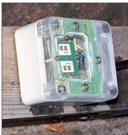
Fig. 7 - Il radar doppler e relativo amplificatore nel suo contenitore ermetico con finestrella RF in PTFE, collocato sul tetto di casa
