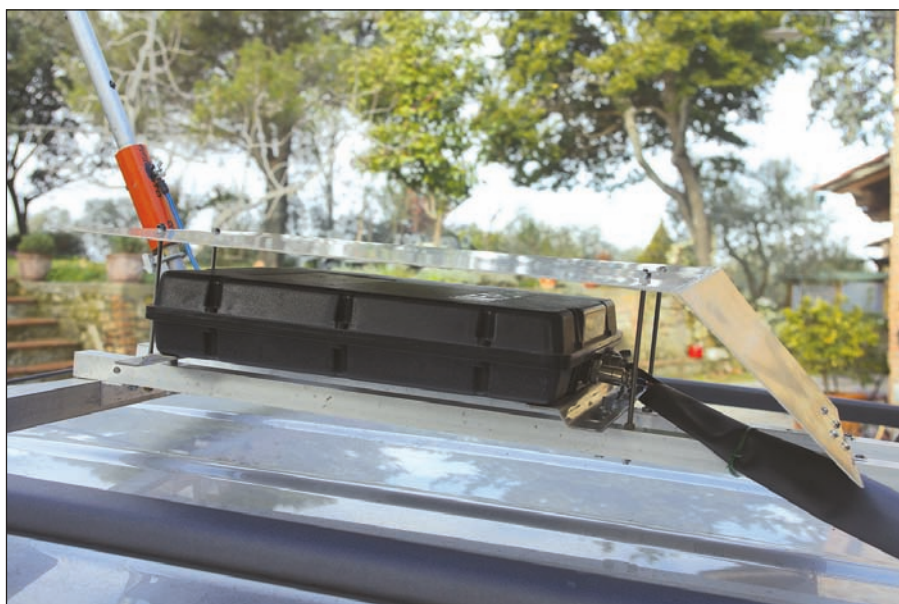
Vista generale della protezione anti-pioggia dell'accordatore
