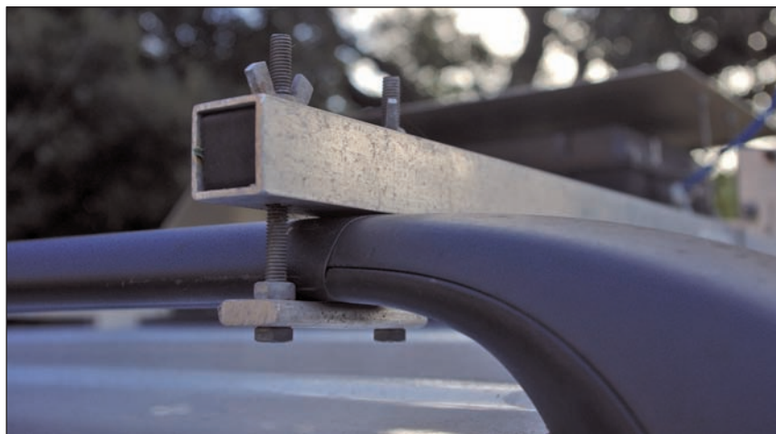
Particolare del fissaggio delle traverse alle barre portabagagli longitudinali di serie
