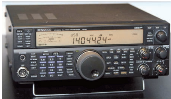
Il Kenwood TS-590 implementa un ricevitore che nelle bande 1.8/3.5/5/7/14/21 MHz, è down conversion fino a 2.7 kHz di selettività, oltre diventa up conversion. Su tutte le altre bande è sempre up conversion. Il rapporto prestazioni / prezzo è ottimo.
