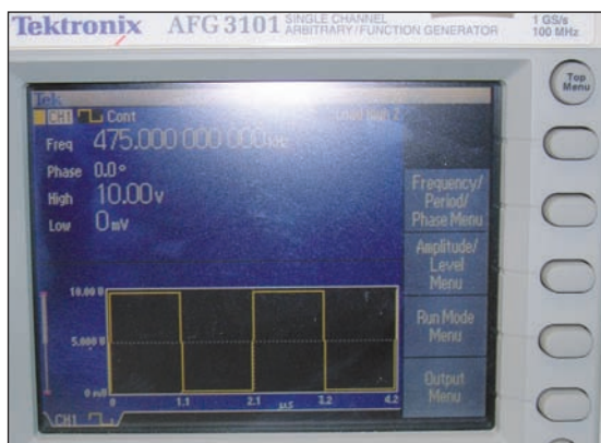
Foto 15 - Prime prove dell'amplificatore – impostazioni del generatore di segnali
