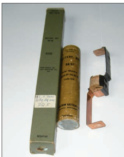
Foto 1 - Batterie originali ed attrezzo per mettere in parallelo due batterie torcia
