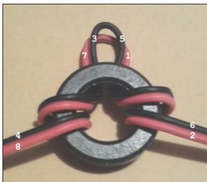
Fig. 3 - Esempio semplificato di avvolgimento di tipo A
