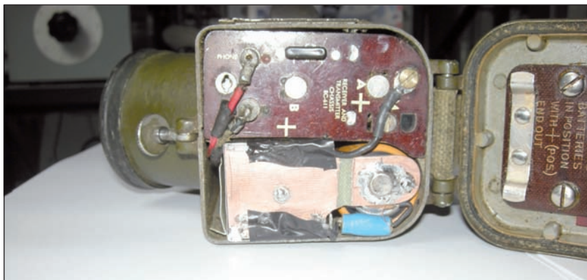
Foto 9 - Alimentatore inserito nel BC 611 (si vedono il relais ed il cavetto con la vite di fissaggio a massa)
