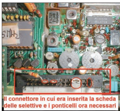
Inserire un ponticello tra il secondo e il terzo pin contando dal pannello anteriore
