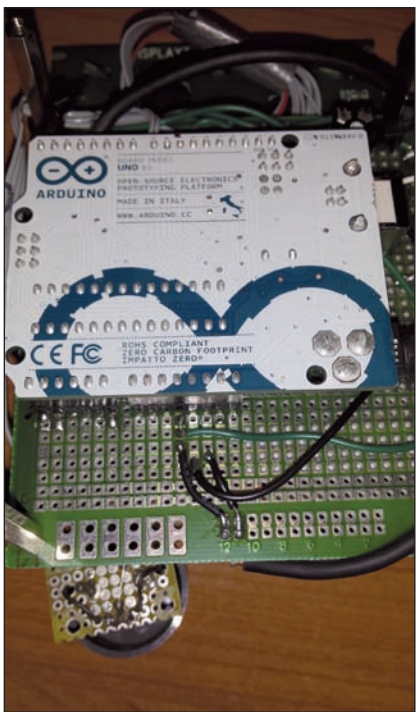
Fig. 10 - Scheda Arduino montata su shield
