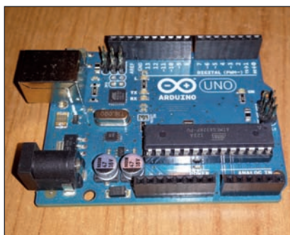
Fig. 2 - Scheda Arduino Uno Rev3.
