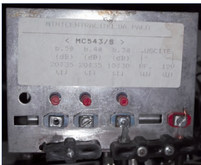
Fig. 8 - Il preamplificatore d'antenna TV- usato nei test
