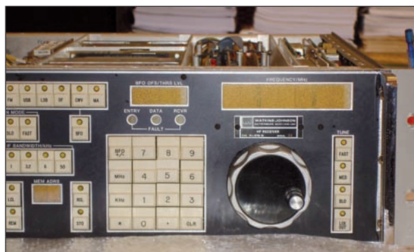
Fig. 5 - Il WJ-8718-19FE S/N 34, modello provvisto di copertura da 5 kHz a 99,999 MHz.
