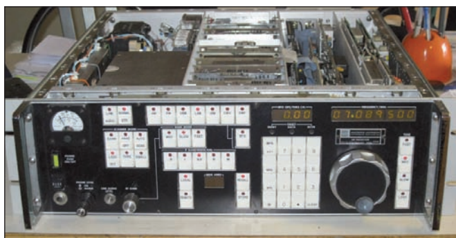
Fig. 4 - Il ricevitore WJ-8718A/NAV/MFP S/N 3332 con varie opzioni installate (preselettore, 1 Hz tuning, 10-Hz BFO, Spectrum Monitor Output ed altre). Si notino il differente strumentino S-Meter/Audio impiegato e pure il piccolo (e rumoroso!) contatore digitale del tempo di funzionamento dell'apparecchio.
