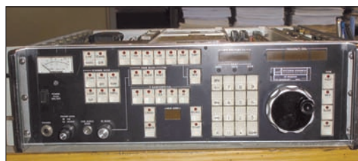
Fig. 3 - Il ricevitore WJ-8718A/MFP S/N 3347 (versione più recente).
