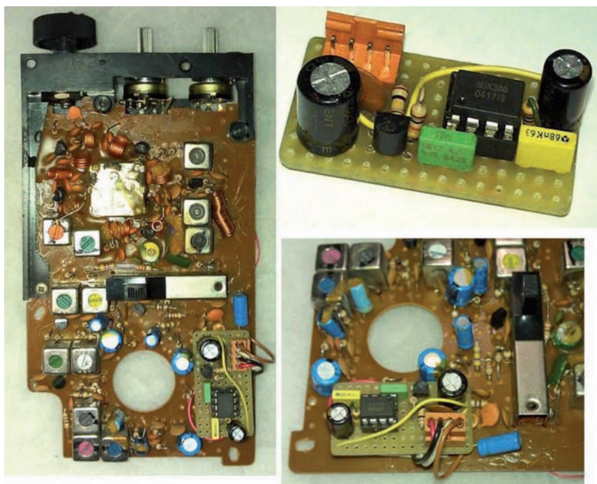
In alto a destra l'amplificatore audio realizzato su una basetta millefori, e come questo è stato applicato nella radio.
