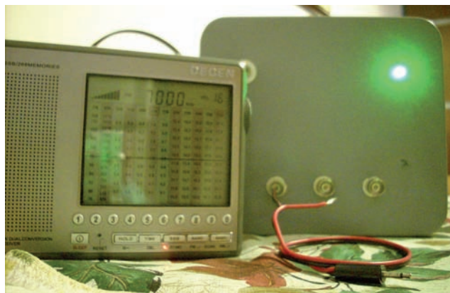
Il segnale a 7MHz del generatore irradiato da 20cm di filo e ricevuto dal DEGEN
