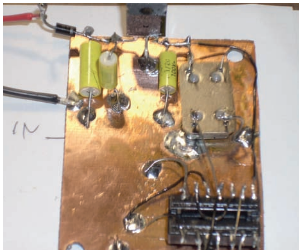
Vista del cablaggio volante sul divisore
