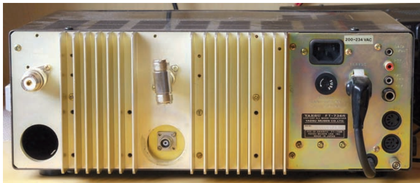
Foto 2 - Il pannello posteriore dell'FT-736R ospita dieci connettori. Il BNC in basso è un'aggiunta del precedente proprietario. Il connettore in alto a sinistra, per i 430 MHz, è un N, ma c'è un raccordo N-UHF.
