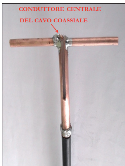
Fig. 7 - Il cavo inserito nel dipolo
