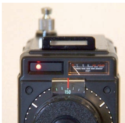
Foto 4 - La scala di sintonia dell'IC-202 ha una tacca ogni 10 kHz. Lo S-meter c'è, ma ha dimensioni minuscole.
