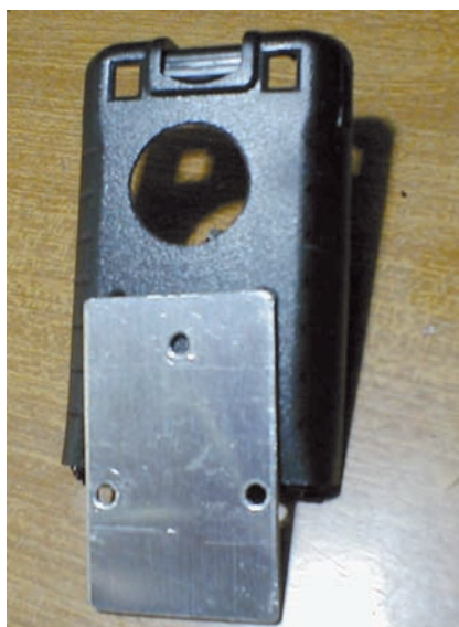
Semiguscio forato e il dissipatore
