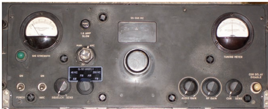
Fig. 1 - Il pannello frontale del ricevitore LTV G-187.
