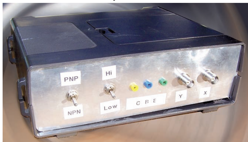
Vista esterna della mia soluzione, recuperando il case di un vecchio multimetro
