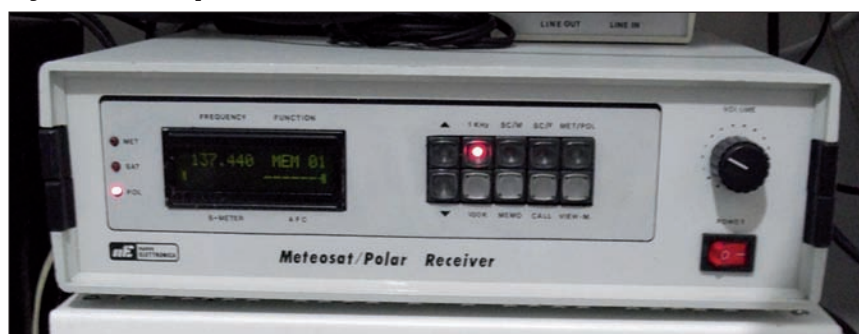
Fig 1 - Il ricevitore per satelliti meteo
