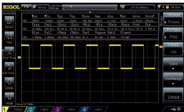
Fig. 3 - Varie misure disponibili nel Rigol DS1074Z con l'opzione "Measure all". In basso si vedono fino a cinque misure senza rubare spazio all'oscillogramma. In questa immagine, in basso, c'è la sola frequenza.
