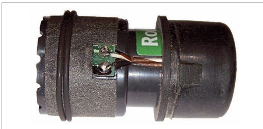
Fig. 2 - MD-100 pronto per l'installazione. Notare la coppia di O-ring (a sinistra) con la funzione di sospensione e l'accessorio di montaggio (a destra) in elastomero morbido
