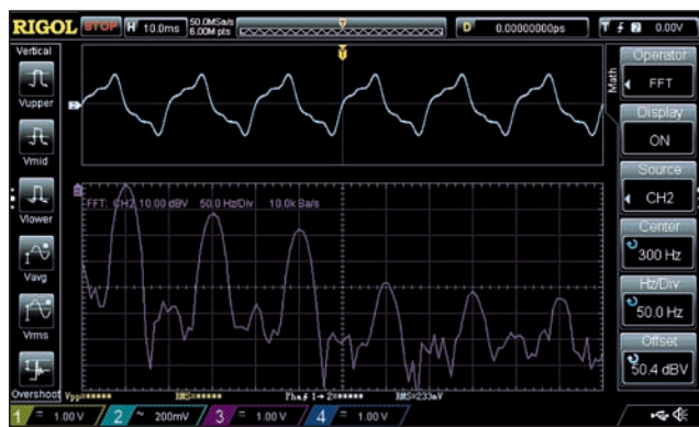
Fig. 5 - In alto la corrente, molto distorta, assorbita dalla ventola di una stufetta. In basso la FFT corrispondente. Si vedono la fondamentale e le armoniche 3, 5, 7, 9 e 11 a -12, -18, -38, -42 e -45 dB circa sotto la fondamentale.
