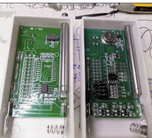
Fig. 3 - Piazzole o jumper attraverso cui è possibile programmare sensori magnetici di apertura porte o finestre
