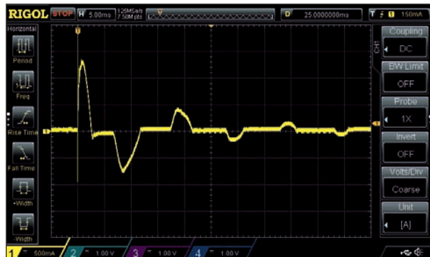
Fig. 1 - Corrente assorbita dall'alimentatore a 230 VAC, al momento dell'accensione. Carico lato DC: 13,8 V e 0,3 A. Scala verticale 500 mA/div, tempi 5 ms/div.
