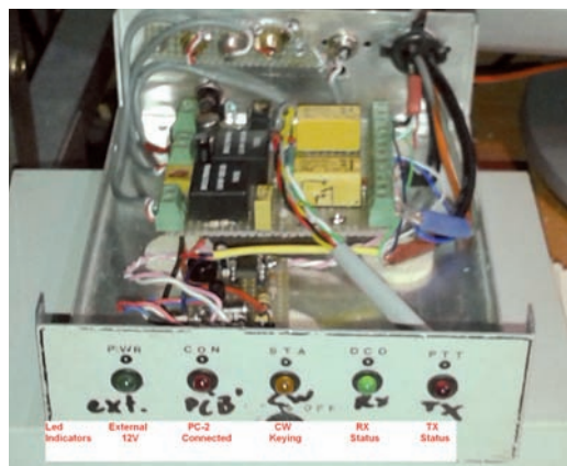
Vista frontale con LED indicatori + Posizionamento delle basette
