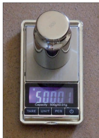
Fig. 3 - Economica bilancia di produzione cinese. Si noti la risoluzione di 0,01 g per una portata di 500 g, pari a 20 ppm. La massa campione è di classe F1. Nonostante il prezzo, circa 8 euro, non è un giocattolo. Il punto decimale non si vede, ma c'è.
