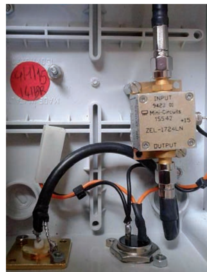
Il preamplificatore ZEL-1724N alla base dell'antenna ad elica.
