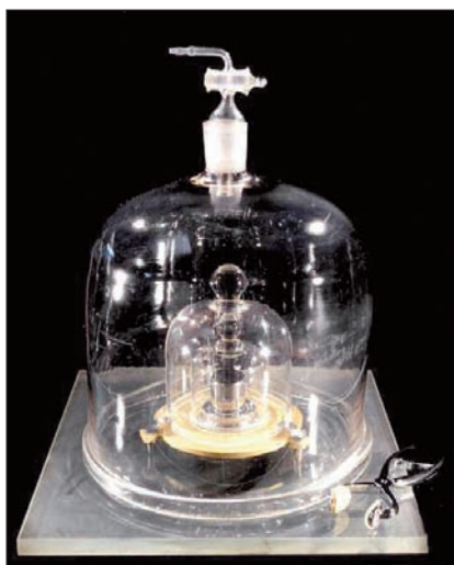
Fig. 4 - L'IPK, il prototipo internazionale del chilogrammo, conservato a Sèvres sotto tripla campana di vetro per proteggerlo dalle contaminazioni.
