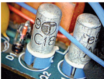
Una coppia di AC187 tradisce l'origine "anni '60" dell'apparecchio
