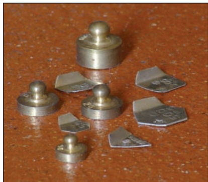
Fig. 2 - Alcune delle masse campione in dotazione alla bilancia di cui all'inizio dell'articolo. Se ne vedono in ottone da 1 a 5 g e in lamierino da 50 a 500 mg.
