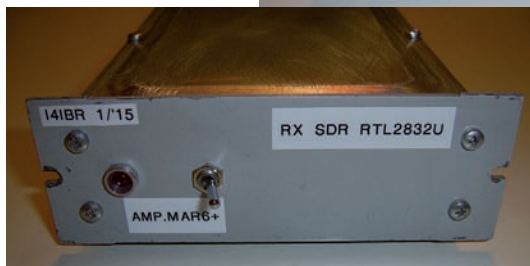
Ricevitore SDR con pre MAR6+ (non utilizzato con il converter)
