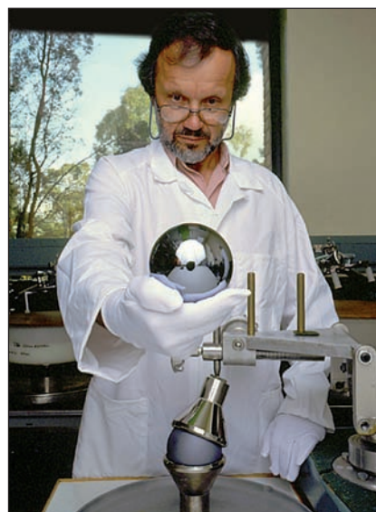
Fig. 6 - Il maestro ottico Achim Leistner, dell'Australian Centre for Precision Optics, mostra un singolo cristallo di silicio di forma sferica che forse un giorno diventerà il nuovo IPK. Si tratta dell'oggetto più perfettamente sferico costruito dall'uomo. Ricerche simili sono in corso anche in Italia. Foto: The Commonwealth Scientific and Industrial Research Organisation of Australia
