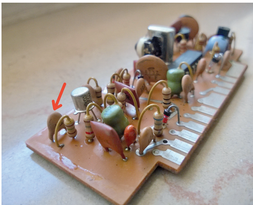
Condensatore da sostituire
