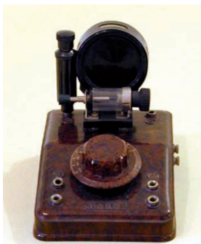
Fig. 3 - Moderna riproduzione di semplice radioricevitore a cristallo di galena
