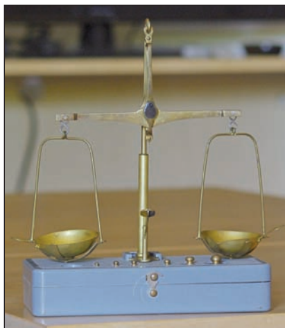
Fig. 1 - La piccola bilancia a bracci uguali acquistata dall'autore alla fine degli anni '60. Si vede la parte superiore dei pesi da 1 a 20 g, quelli da 50 a 500 mg sono nel loro ricettacolo sulla sinistra
