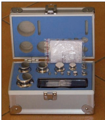
Fig. 5 - Pesiera di classe F1. È un cofanetto, con masse in acciaio inox 304. I valori sono compresi tra 1 mg e 500 g. Si vede, ripiegato, il certificato di calibrazione. Fonte Ebay, susanldy.
