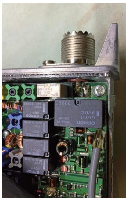
Fig. 3 - Apparato prima della rimozione del connettore PL originale.
