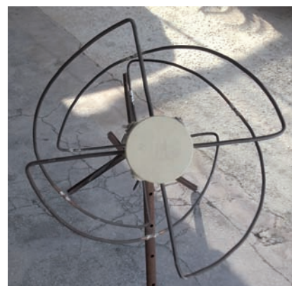
Fig. 5 - Inserimento dei tubi sagomati, nei fori praticati sul palo di sostegno
