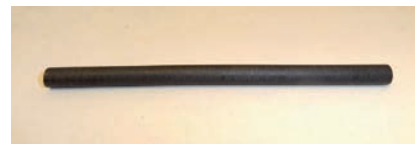
Foto 2 - Ferrite isolata con biadesivo e carta
