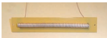
Foto 3 - Piastra con bobina avvolta sulla ferrite
