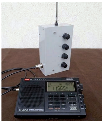
Foto 7 - L'antenna durante una prova con ricevitore portatile
