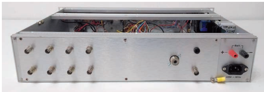
Parte Posteriore del Rack con otto uscite ricevitore
