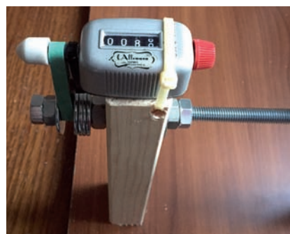
Contagiri bloccato con fascetta Legrand... la cinghia di trasmissione è realizzata con elastico largo circa 10 mm e spessore 2 mm tagliato ad una lunghezza di 12,5 mm e giuntato con una pinzatrice.
