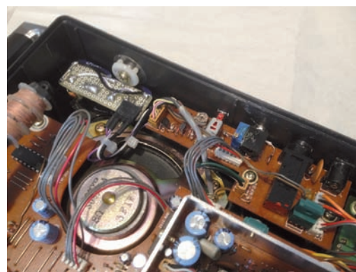
Fig. 12 - La foto mostra le modifiche apportate e l'ubicazione dei componenti aggiunti ( trimmer e basetta supercondensatori) all'interno dell'apparecchio.
