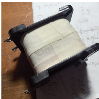
Trasformatore Geloso del G223 da ribobinare il secondario perché bruciato....
