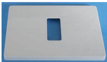
Fig. 4 - La placchetta usata come distanziatore fra patch e schermo.
