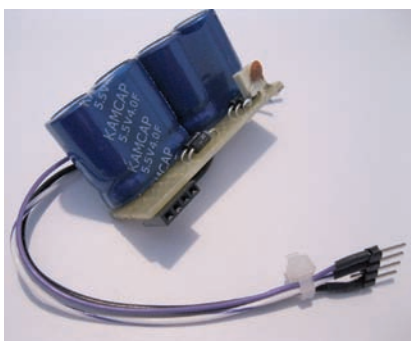
Fig. 11 - La basetta millefori che ospita i "supercondensatori" ed i diodi Schottky è stata dotata di connettore multipolare stripline per il collegamento con i circuiti interessanti del ricevitore.
