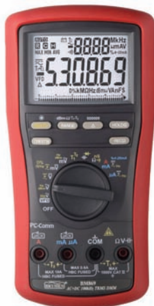
Foto 1 - Il multimetro usato per le verifiche (Brymen BM869S).
