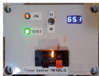
Fig. 7 - Provozener usato per misurare la tensione di innesco di una piccola lampadina al neon
