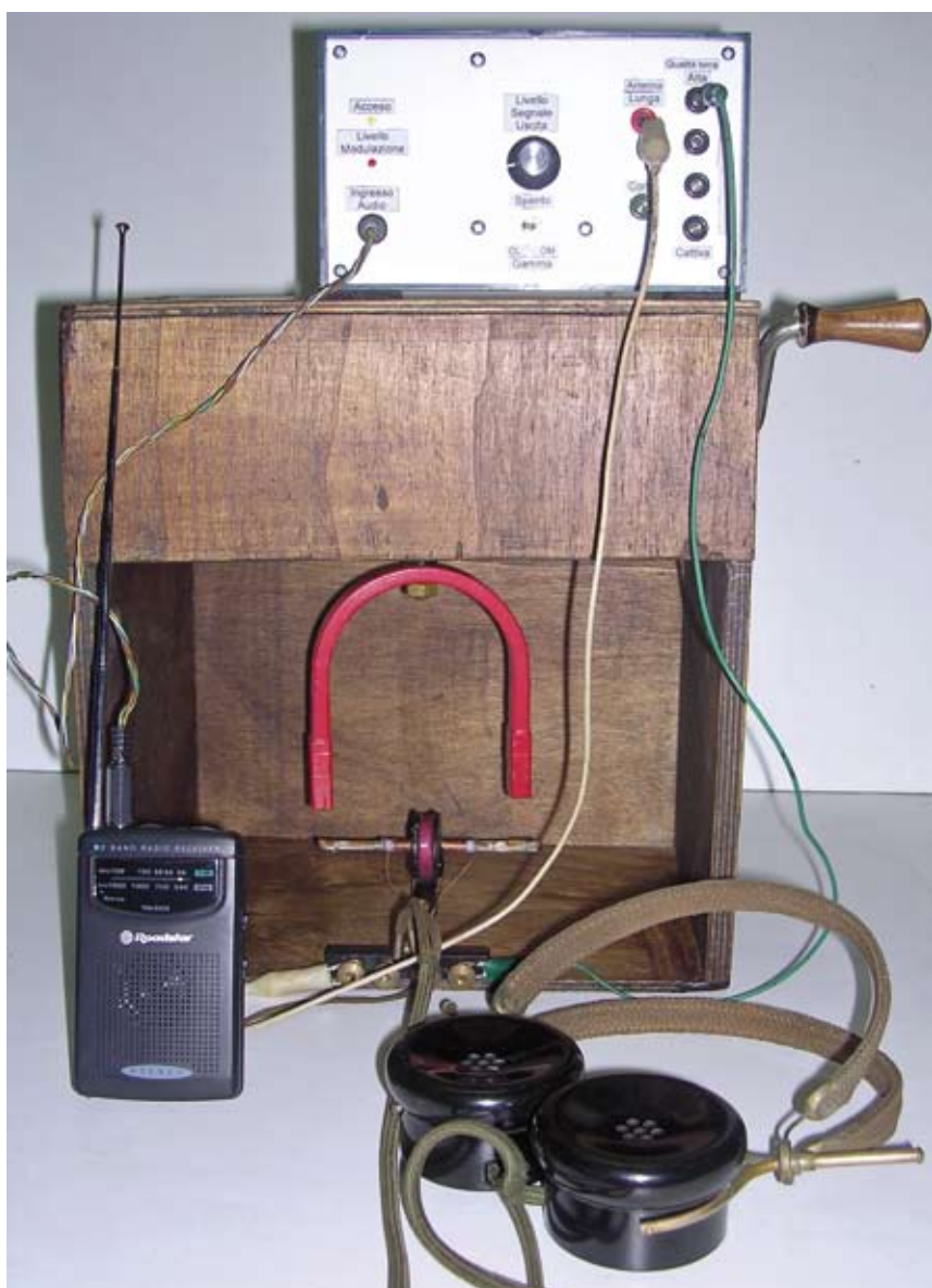
Fig. 5 - Collegamento con un rivelatore magnetico Marconi del secondo tipo, a magneti mobile; alcuni testi lo riportano come primo tipo, in quanto non tengono conto del prototipo con trascinamento manuale realizzato nella famosa scatola di sigari. Di questo particolare Maggie non restano molte tracce perché venne usato solo per un periodo di tempo limitato, prima di essere sostituito da quello con le due pulegge ed il cavetto di acciaio; come l'altro anche questo rivela indifferentemente segnali telegrafici o modulati in ampiezza. E' interessante sentirlo in funzione, in quanto è possibile fare alcune osservazioni sulle variazioni dell'intensità dell'audio in cuffia quando i poli del magnete si allontanano e si avvicinano al gruppo delle bobine; Marconi le aveva trascritte in un'apposita memoria perché su ascolti in condizioni difficili potevano divenire rilevanti. Non c'erano le valvole e tutto il funzionamento della stazione ricevente era basato su questo particolare dispositivo: ricostruirlo e metterlo in funzione è un'esperienza tecnica da non perdere.
