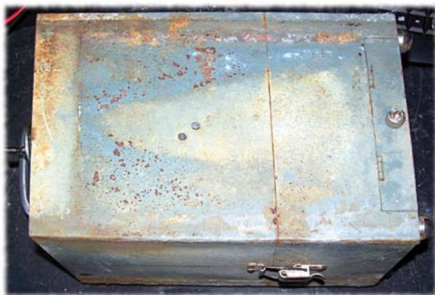
Fig. 3 - In contenitore del mio esemplare. Notare le vaste aree ossidate e le mufte. A destra lo sportellino per accedere al cavo per l'alimentazione esterna.
