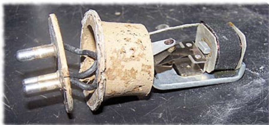
Fig. 4 - L'oscillatore meccanico (vibratore), cuore del circuito elevatore di tensione
