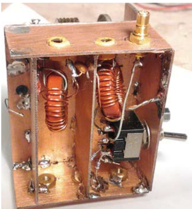
Vista laterale interna del preselector. Si vedono: L1, L2 e attenuatore
