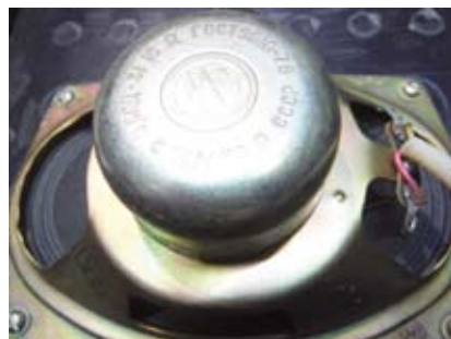
Fig. 5 - Dettaglio dell'altoparlante interno da 16 ohm e con magnete di grosse dimensioni.
