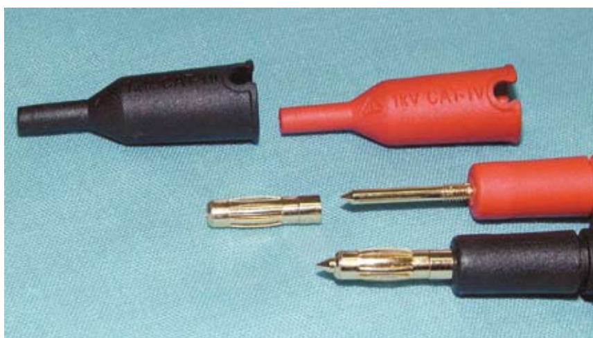
Fig. 4 - Kit da applicare ai puntali. Le parti metalliche trasformano i puntali in "banane" adatte per basse tensioni. I cappuccetti nero e rosso, applicati ai puntali, ne fanno sporgere solo pochi mm di metallo e sono indispensabili per puntali di CAT III e superiori (in foto CAT IV 1.000 V).
