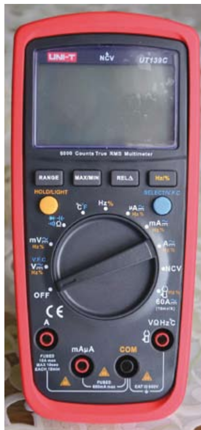
Fig. 1 - L'Uni-T UT139C è uno strumento di buona qualità: True RMS e CAT III 600 V, portate \mu A , mA, A con fusibili e terminali separati da quello per le tensioni. Il costo contenuto è adatto a ogni dilettante
