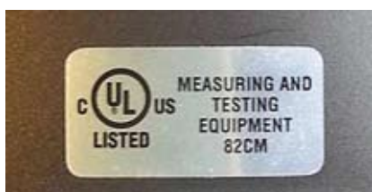
Fig. 3 - Il marchio UL che certifica, come altri simili, l'avvenuta verifica delle caratteristiche di un multimetro ad alta sicurezza.
