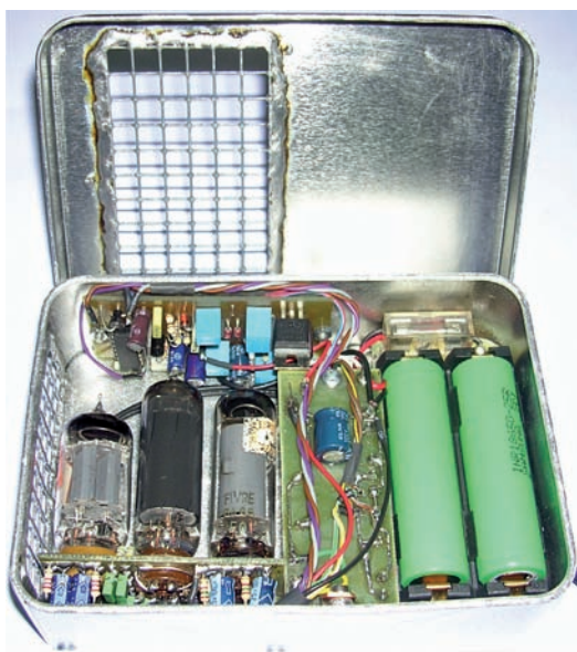
Fig. 5 - Vista interna dell'amplificatore. A destra si notano le due pile al litio. Le valvole qui installate sono una ECC82 e due 6AQ5.
