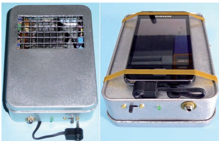
Fig. 6 - Aspetto complessivo dell'amplificatore, corredato dell'iPod. Anche se il fissaggio tramite fettucce elastiche può sembrare un pò artigianale o empirico è a conti fatti la soluzione migliore. Non è consigliabile danneggiare il mobiletto per mettere in opera elementi di fissaggio stabili: se in seguito vi capitasse di dover sostituire l'iPod con un altro modello di dimensioni differenti potreste trovarvi in difficoltà. Come soluzione intermedia si può acquistare la sua borsetta - custodia dedicata e incollarcela, però anche così c'è il rischio di danneggiare la vernice di finitura che avete applicato.
