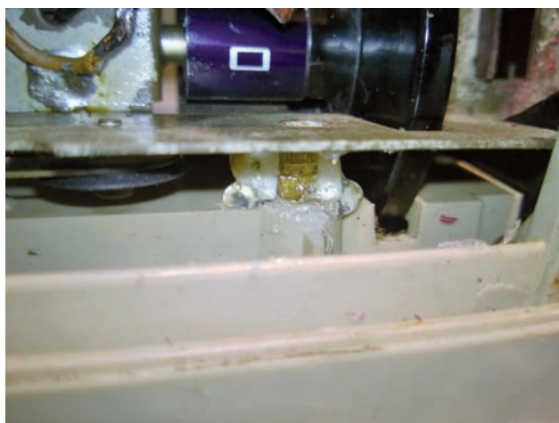
Riparazione inserto telaio
