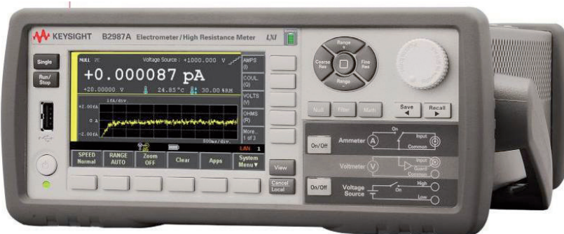
Fig. 5 - Per misure di tensione che non influenzino il circuito in prova, il Keysight B2987A è una delle migliori soluzioni. Ha solo due portate voltmetriche: 2 e 20 V, ma con risoluzioni di 1 e 10 \mu V e resistenza d'ingresso maggiore di 200 T \Omega (200.000 G \Omega ). E fa tante altre cose.
