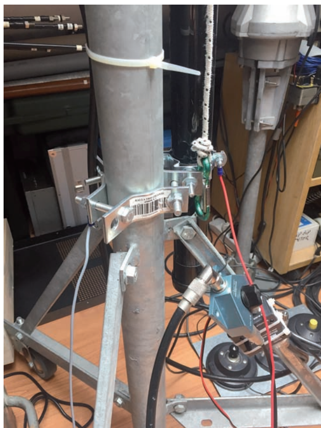
Foto relativa alla linea radiante RF avvolta a spirale sull'antenna realizzata con canna da pesca e foto del Balun da 2 kW inscatolato e collegato con adattatore all'accordatore MFJ 994 BRT da palo. Il Balun deve essere ancora collegato al filo radiante RF della canna da pesca.
