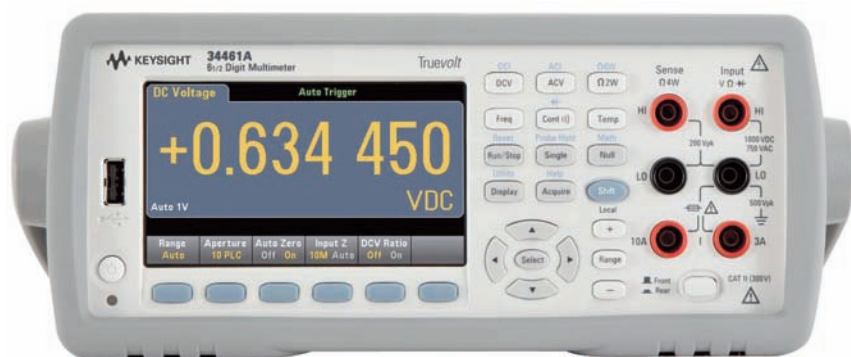
Fig. 4 - Il Keysight 34461A è un multimetro da banco di grandi prestazioni e prezzo non troppo alto. Per le portate di 100 mV, 1 V e 10 V la resistenza d'ingresso si può scegliere tra 10 M \Omega e oltre 10 G \Omega
