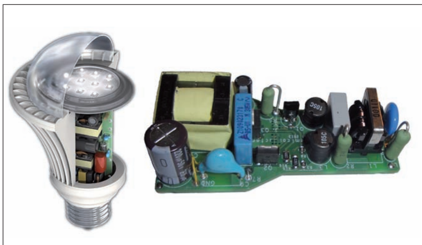
Fig. 3 – Le parti che compongono una lampada LED di alta potenza ed efficienza energetica. Alla destra un modulo di alimentazione che implementa un convertitore flyback compatibile anche con la funzione dimmer.
