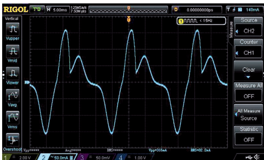
Fig. 3 - Forma d'onda della corrente assorbita dal semplice alimentatore con trasformatore, diodo e condensatore
