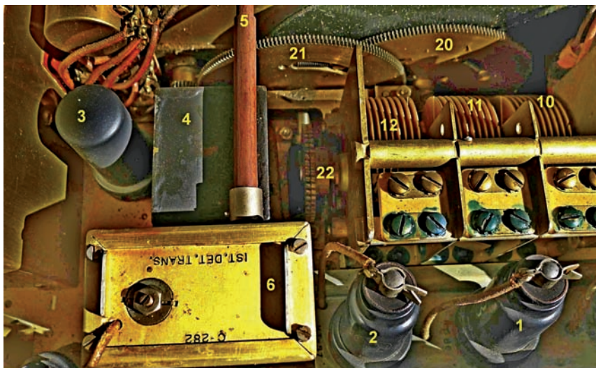
Fig. 4 - Particolare con gli ingranaggi della sintonia.
