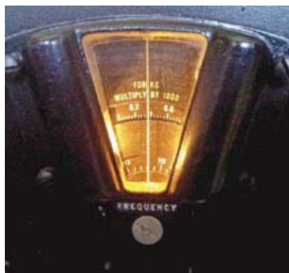
Fig. 13 - L'affascinante scala dei BC-312/342 in ascolto sulla banda broadcasting dei 49 metri. Sono visibili solo due scale: quella della gamma prescelta e quella in basso che conta i giri della sintonia fine.
