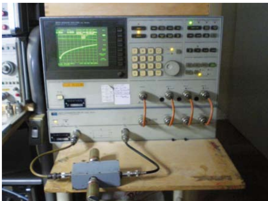
Foto 4 - Il ponte collegato al Network Analyzer
