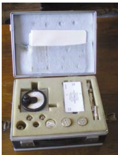
Foto 3 - Interno: si vedono il ponte riflettometrico, i tre riferimenti 75 e 50 ohm, il condensatore variabile e accessori vari.
