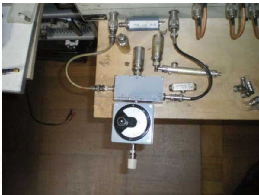
Foto 7 - Misura di riflessione (compensata con il variabile) di una chiusura ethernet 50 ohm
