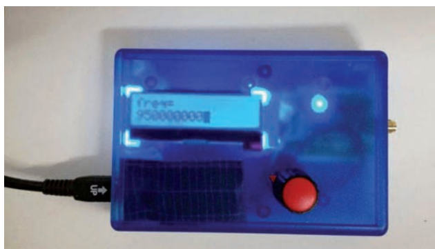
Fig. 4 - Fase di impostazione della frequenza (notare che il cursore lampeggia sull'HERTZ, scegliendo da menù la impostazione dello STEP si può cambiare lo step di regolazione)
