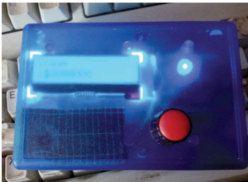
Figura 1 - Generatore assemblato rapidamente in un box di plastica trasparente
