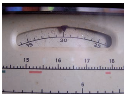
Foto 4 - Finestrella con scala di sintonia centesimale
