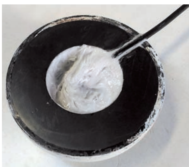
Riempimento con silicone bianco per isolare e proteggere le saldature SMA
