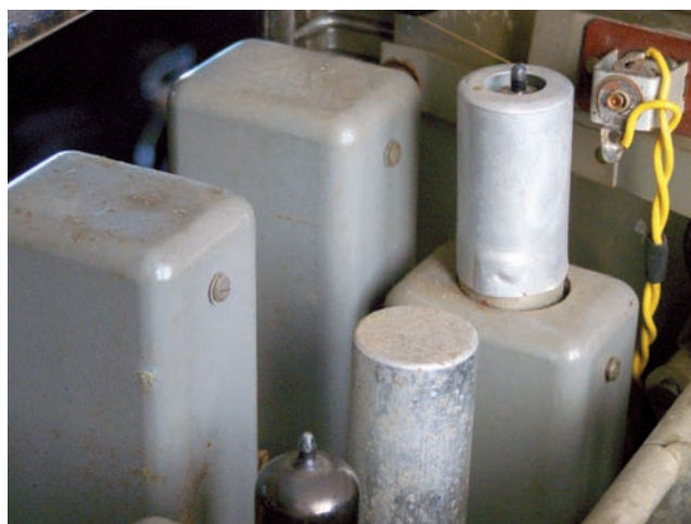
Foto 3 - Interno del ricevitore con trasformatori FI e valvola BFO
