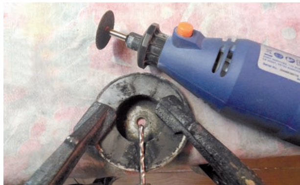
Preparazione passaggio cavo RG174. Non è possibile forare il magnete, ma limando con pazienza si riesce a fare un canalino da 3 mm.
