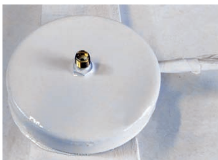
Verniciatura smalto, prima della chiusura finale. Il colore bianco scalda meno la base magnetica sotto il sole italiano...
