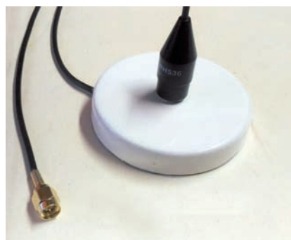
Cavo RG174 è stato tagliato a 273 cm pari a 2 \lambda 145 MHz per fattore velocità 0.66
