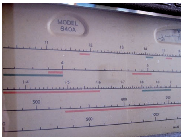
Foto 2 - Scala parlante ampia e luminosa che evidenzia le bande BC e HAM
