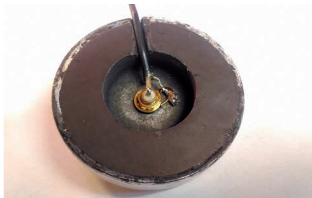
Cavo RG174 saldato e connettore SMA femmina pronto ben serrato.
