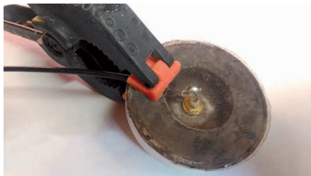
Il cavo viene bloccato con colla ciano nel canalino di passaggio, la protezione plastica autoadesiva è provvisoria.
