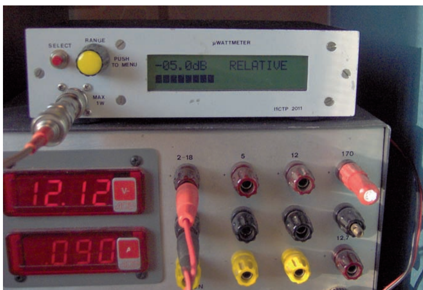
Foto 8 - Misure dell'attenuazione (-5dB)
