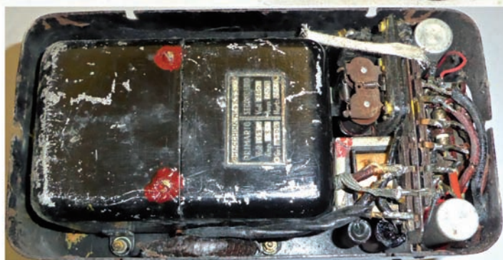
Fig. 7 - Due dynamotor italiani nel loro contesto d'uso. In alto la stazione trasmettente militare SITI tipo V3 (1927). Il dynamotor forniva circa 140 watt a 800 volt per la sezione trasmissente ed era costruito dalla Marelli. In basso il dynamotor dell'autoradio Phnola 610 (1937): produce circa 280 volt e 80 mA, bastanti per alimentare una 6N7 finale con i triodi in controfase. Sono visibili le impedenze antidisturbo collocate in prossimità del generatore: è interessante la targhetta che lo equipara ad un trasformatore; invece di ingresso e uscita c'è scritto primario e secondario.
