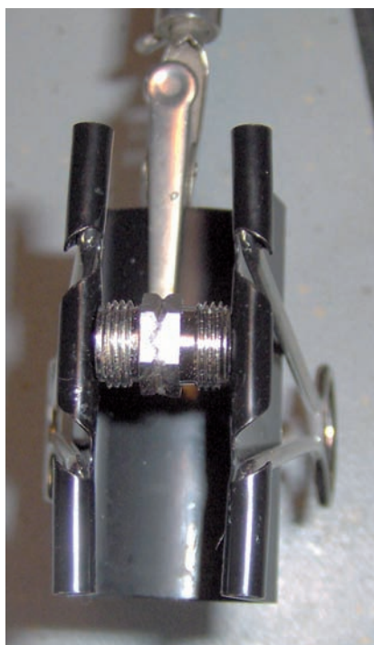
Foto 2 - Saldo fra i due pressacavi
