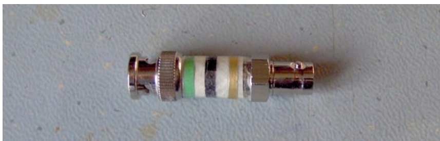
Foto 9 - Aggiungo una fascia con l'indicazione dell'attenuazione nel codice "colori"
