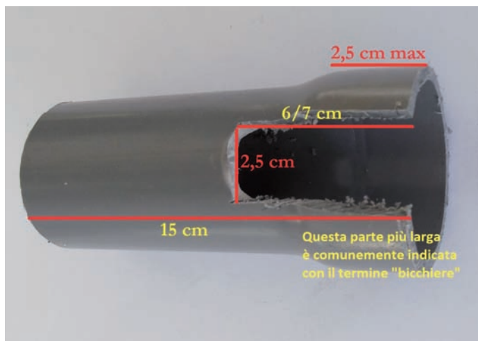
Fig. 10 - Preparazione del tubo
