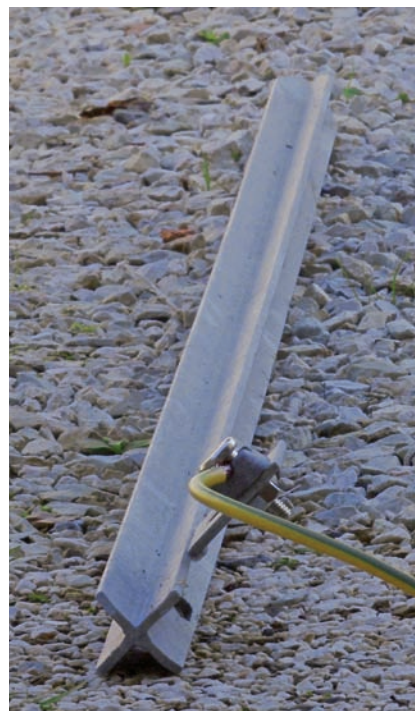
Fig. 7 - Dispersore zincato a croce lungo 1,5 m con il conduttore di terra collegato provvisoriamente.
