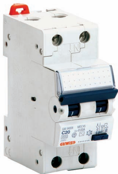
Fig. 2 - Interruttore differenziale Gewiss da 30 mA. L'apparecchio è combinato con un magnetotermico C20 in grado d'interrompere 4.500 A. Il pulsante nero a sinistra dei punti e della scritta rossa è il pulsante di test
