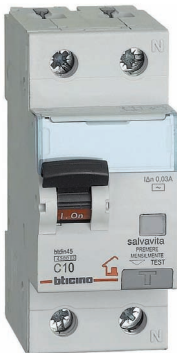
Fig. 3 - Interruttore differenziale Bticino da 30 mA. Comprende un magnetotermico C10, adatto a un circuito luce e prese da 10 A. Il pulsante grigio accanto al logo "bticino" è il pulsante di test.
