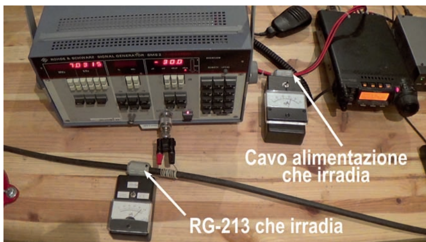
Fig. 7 - In questa configurazione (banda 40m) il cavo coassiale è soggetto a correnti di modo comune e irradia; il cavo di alimentazione dell'apparato irradia altrettanto!
