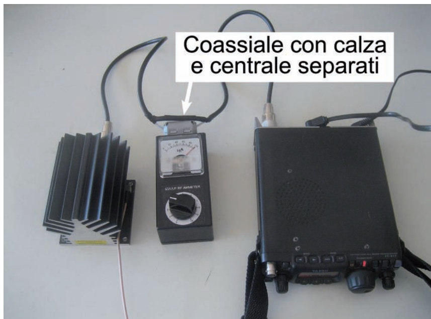
Fig. 6 - Misura di antenna end-fed: come si vede, irradia tanto il filo cosiddetto "radiante" quanto il coassiale!
