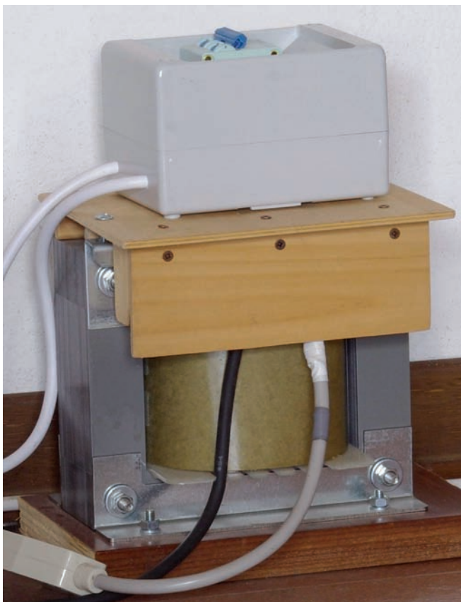
Fig. 3 - Trasformatore Trasfostatik da 1.000 VA con copertura di protezione home made e magnetotermico con SPD da fissare alla parete.
