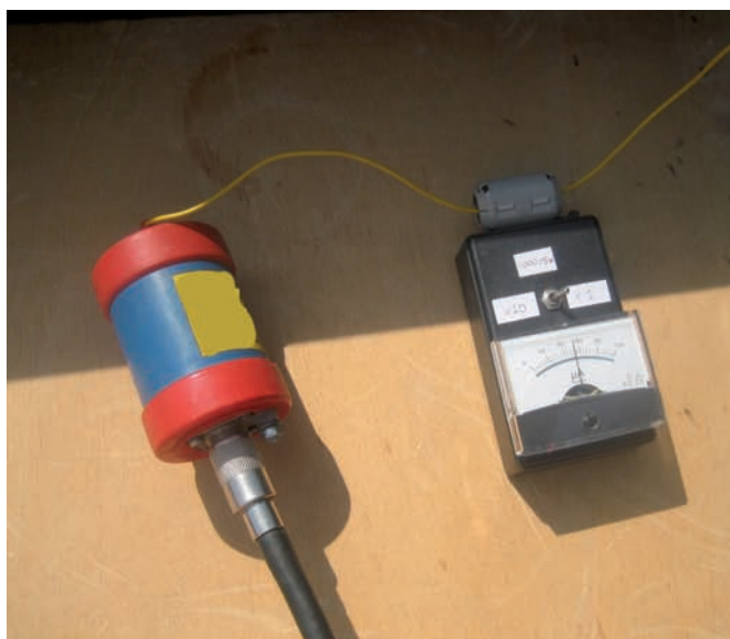
Fig. 6 - Misura di antenna end-fed: come si vede, irradia tanto il filo cosiddetto "radiante" quanto il coassiale!
