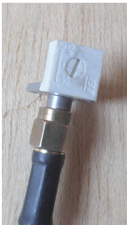
Fig. 6 - Trimmer da 500 \Omega che, saldato ad un connettore SMA, consente di simulare la taratura di un'antenna
