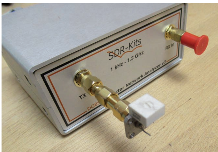
Fig. 8 - Dopo la taratura, il valore di ROS effettivamente raggiunto sul trimmer è misurato per verifica con un analizzatore vettoriale ottenendo un valore di 1.07.
