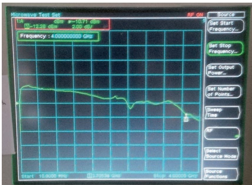
Fig. 6 - Banda passante di \pm 2 dB da 40 a 4000 MHz
