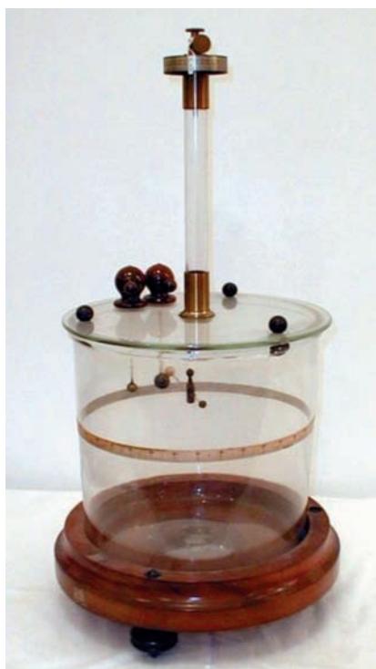
Fig. 5 - Riproduzione della bilancia di torsione di Coulomb (Museo Traversi, Venezia)
