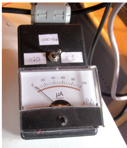
Fig. 12 - La corrente di modo comune tra choke e ricetrasmittitore, rilevata in trasmissione, deve essere nulla.
