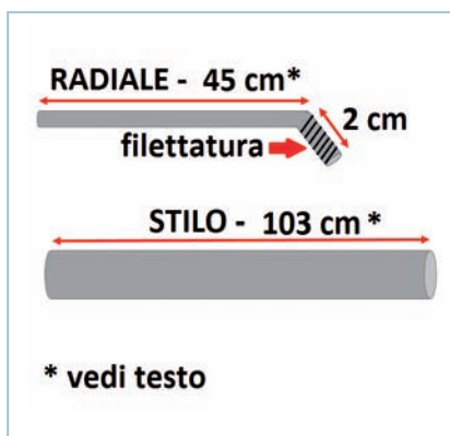
Fig. 7 - Dimensioni dello stilo e dei radiali
