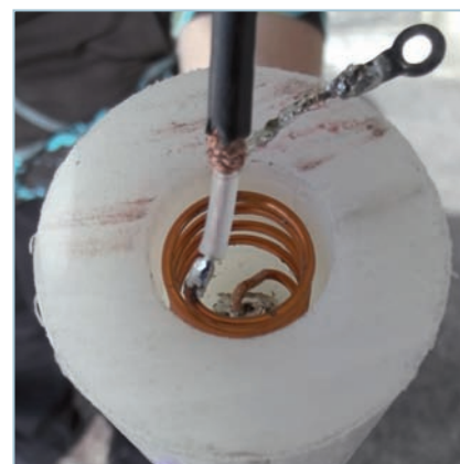
Fig. 10 - Parte inferiore dello stilo di teflon, dopo l'inserimento della bobina
