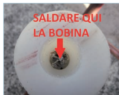
Fig. 9 - Parte inferiore del cilindro di teflon, dopo l'inserimento dello stilo
