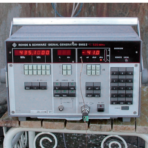
Fig. 5 - Generatore di segnale, dotato di dipolo UHF, posto sul lastrico solare per fornire un debole segnale di riferimento
