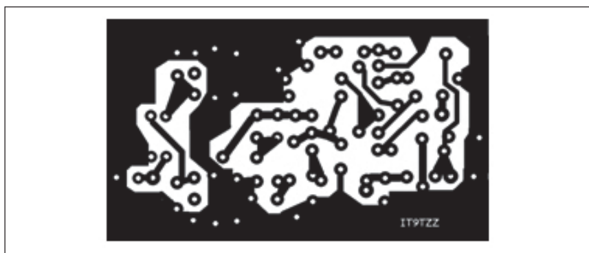
Fig. 5 - Circuito stampato VFO
