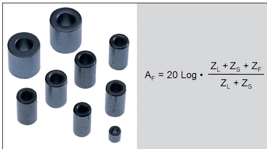
Fig. 6 - Perline di ferrite (bead cores) di varie misure per l'impiego su linee di segnale ed alimentazione in funzione di contrasto alle problematiche RFI. La relazione permette il calcolo dell'attenuazione in funzione delle impedenze sul circuito.
