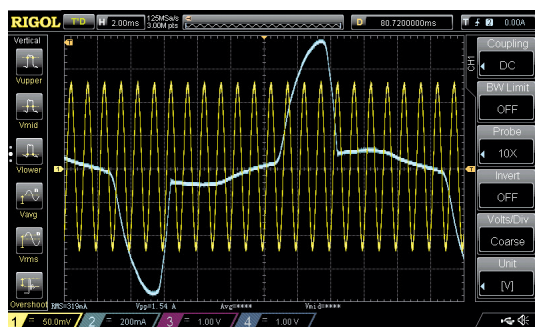
Fig. 5 - In celeste la corrente assorbita lato 230 Vac. Ampli JVC SA-22 con 25 W output a frequenza 1.000 Hz. In giallo il segnale a 1.000 Hz sul carico.
