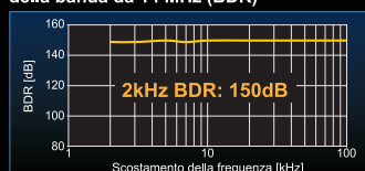
Gamma dinamica di blocco della banda da 14 MHz (BDR)
