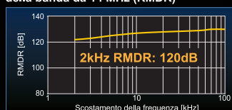
Gamma dinamica reciproca al mixer della banda da 14 MHz (RMDR)
