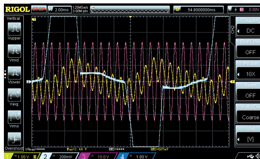
Fig. 7 - Come Fig. 6 salvo che il particolare della corrente di rete è attorno allo zero. Anche qui, come in Fig. 6, sulla corrente di rete non si vede alcuna traccia di componenti legate alla frequenza di uscita (1.000 Hz).
