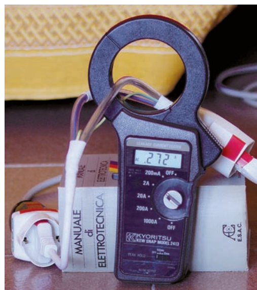
Pinza per la ricerca delle correnti di perdita (Kyoritsu 2413). La portata minima è 200 mA. Misura solo correnti e solo in alternata. La manopola del cambio portata non è quella originale.
