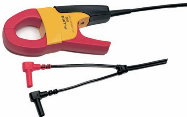
Questa pinza amperometrica (Fluke i400) non funziona da sola, ma dev'essere abbinata a un multimetro.
