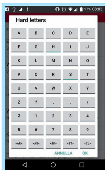
Figura 4 - Funzione di programmazione delle hard-letters : le lettere evidenziate saranno trasmesse con frequenza maggiore delle altre.
