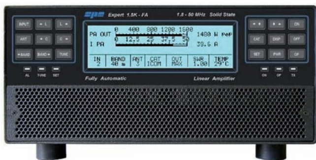
Ecco come si presenta l'EXPERT 1.5K-FA (II serie): vista di frontale: il display, le tastiere con i comandi e le segnalazioni a LED ed in basso il filtro di aspirazione.
