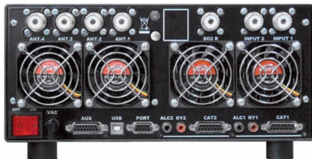
Vista posteriore: sette Connettori RF, vari connettori di servizio per i collegamenti esterni, quattro ventole, interruttore generale ON/OFF.
