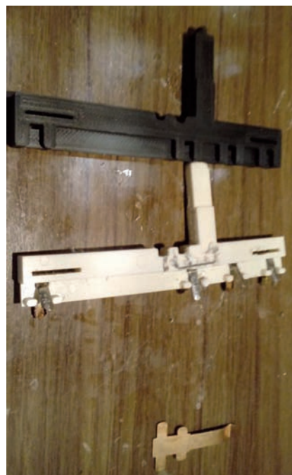
Commutatore riparato e versione rifatta in stampa 3D
