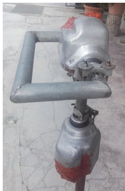
Fig. 5 - Supporto per l'ancoraggio della parabola, a montaggio ultimato.
