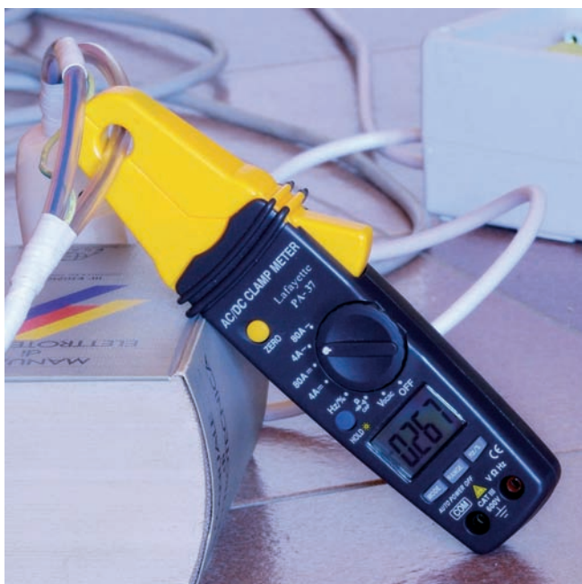
La pinza Lafayette PA-37 misura una piccola corrente alternata (0,267 A). La portata minima dello strumento è 4 A, sia in alternata che in continua.
