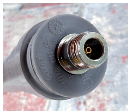
Fig. 5 - Connettore N di alimentazione dell'antenna
