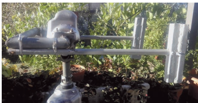
Fig. 7 - I contrappesi montati
