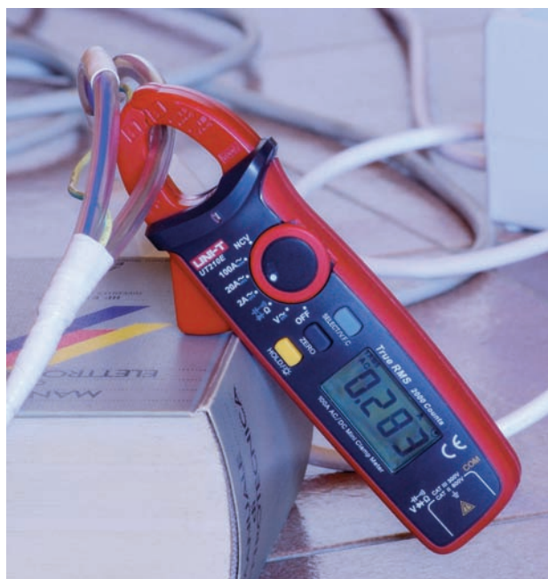
Pinza UT210E al lavoro. L'indicazione è True RMS, la portata minima 2 A, sia in alternata che in continua
