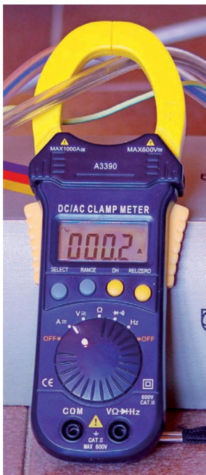
La pinza A3390, di uno sconosciuto produttore cinese, ha una portata minima di 400 A, troppo alta per misurare una corrente di circa 0,28 A.
