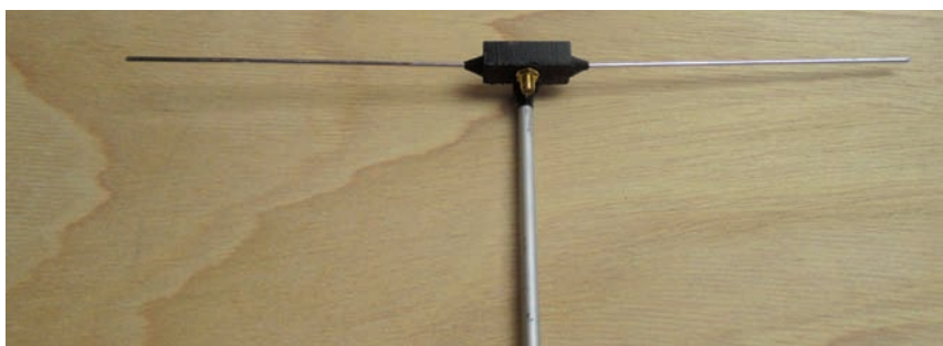
Fig. 5 - Uno dei dipoli di riferimento realizzati con stampa 3D
