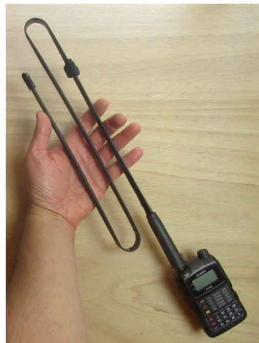
Fig. 2 - Antenna ripiegata in tre segmenti; il radiatore può essere piegato in qualunque punto
