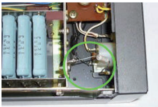
Fig.15 - Montaggio della resistenza da 56 ohm
