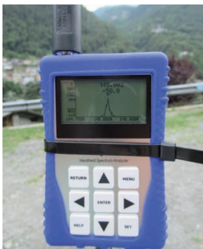
Fig. 9 - Dettaglio dell'analizzatore di spettro; la misura è stata fatta usando la funzione di mediazione su misure multiple.
