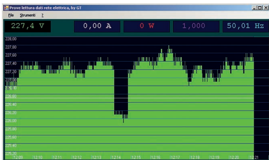
Fig. 5 - Normale andamento della tensione a casa dell'autore. Il calo di oltre 1 V è dovuto all'accensione del microonde. Scala delle ampiezze: 0,2 V/div, da 225,2 a 228 V. La misura è solo della tensione.
