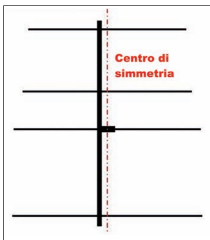
Fig. 7 - Nel realizzare gli elementi si tenga presente che, data la conformazione dell'elemento radiante, il centro di simmetria dell'antenna non corrisponde al boom.
