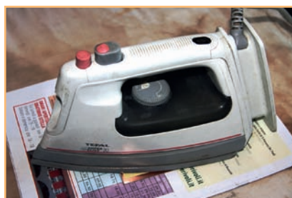
Foto 2 - Il trasferimento termico sulla piastra a CS.
