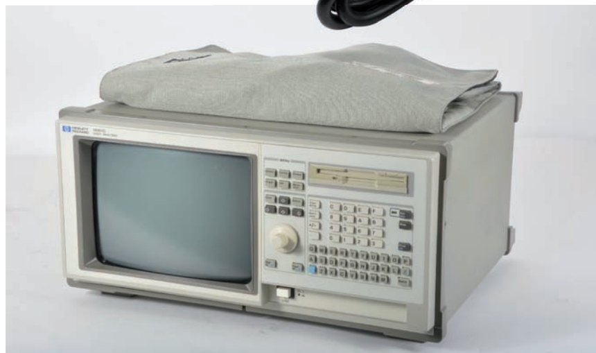
Fig. 1 - Analizzatore di stati logici HP1661 di qualche decennio fa: un colosso da 13kg
