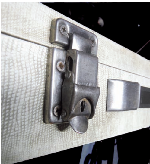
Fig. 1 - Dettaglio delle chiusure a scatto con serratura della valigetta
