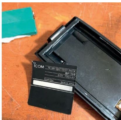
In alto a sinistra alcune delle batterie Ni-Mh estratte e da sostituire.
