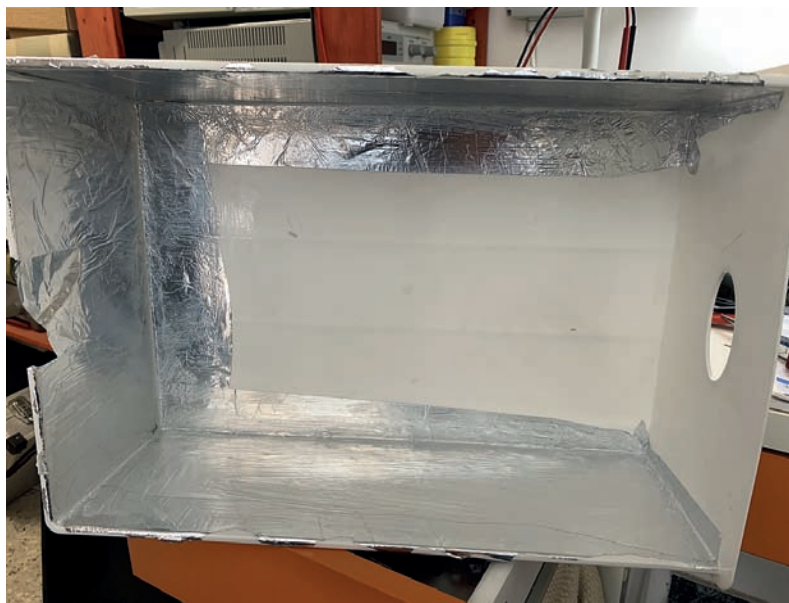
Foto 2 - L'applicazione dell'alluminio all'interno della camera di sterilizzazione.
