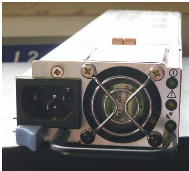
Fig. 1 - Alimentatore Dell, il frontale con i tre LED che ne indicano lo stato.
