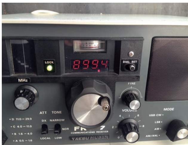
Fig. 9 - Il nuovo display a quattro cifre, con sovrapposta pellicola rosso-trasparente, indica i kHz e le centinaia di Hz.
