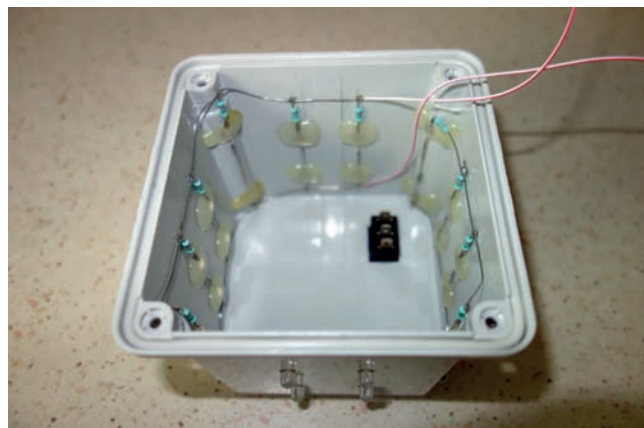
Foto 4 - Collegamenti interni dei LED.
