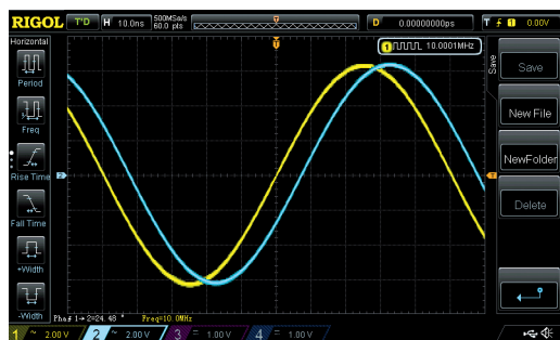
Fig. 3 - Confronto di fase tra i segnali di due OXCO. La traccia gialla (1) è in leggero anticipo rispetto alla blu (2). La fase della 1 rispetto alla 2 è +24,48 gradi, ma non fatevi trarre in inganno: l'accuratezza reale della misura è assai minore, intorno al grado.
