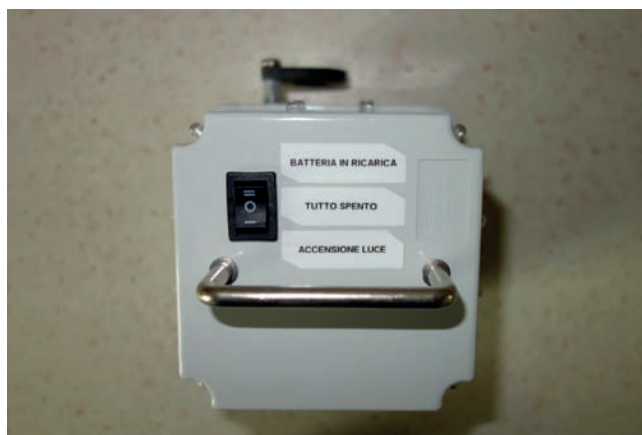
Foto 6 - Le etichette che ricordano l'operatività del deviatore.
