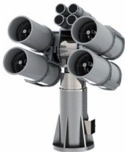
Fig.6 - Telescopi su giunto cardanico del terminale di terra di Lasercom.
