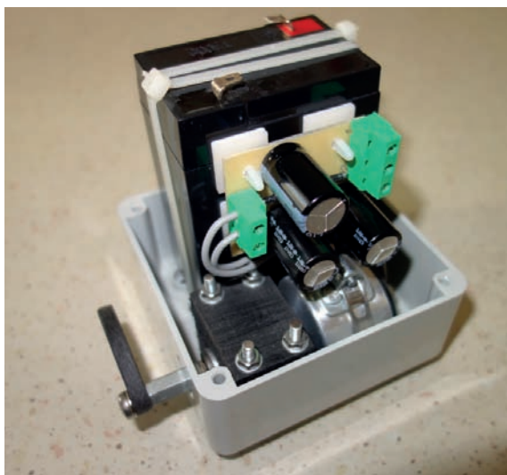
Foto 1 - Vista delle parti interne della lanterna.
