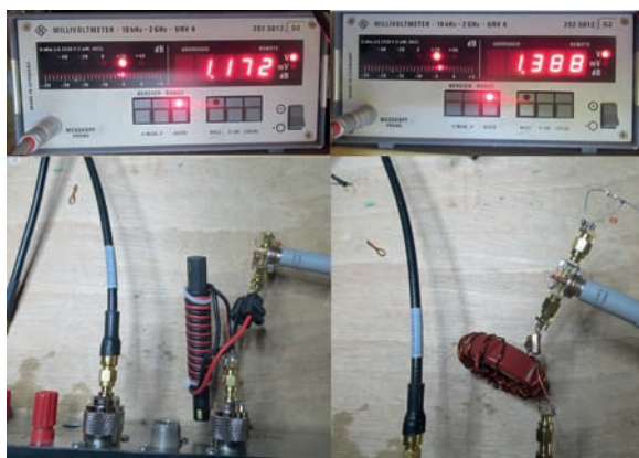
Fig. 10 - Confronto tra i due trasformatori connessi ad uno stesso carico disadattato calcolato per riprodurre l'impedenza che ha la mia Rybakov a 14.100MHz. I due trasformatori sono alimentati da un generatore di segnali tramite un accordatore MFJ 949E. Come dimostra il millivoltmetro RF, il trasformatore con T200-2, che produce ROS più elevato, ha in realtà prestazioni superiori a quelle della barretta di ferrite (+1.47dB in potenza).
