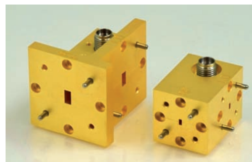
Fig. 6 - Mixer su package con guide d'onda alla porta RF ed LO, connettore alla porta IF.
