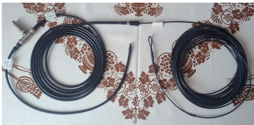
Foto 3 - Antenna J-Pole per i 20 metri
