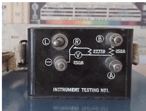
Foto 3 - Schema elettrico e boccole di connessione del tester.
