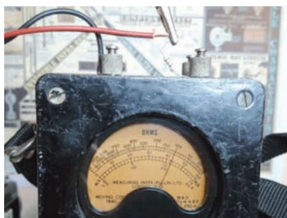
Foto 22 - Misura di un resistore da 10 \Omega , 5%, portata 500 \Omega (indice su 100, scala 1).
