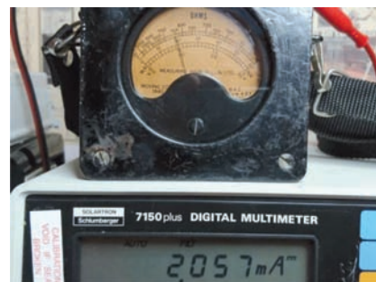
Foto 16 - Misura corrente continua, portata 6 mA (indice sul 20, scala 2).
