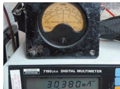
Foto 17 - Misura corrente continua, portata 60 mA (indice sul 30, scala 2).
