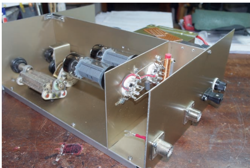
In costruzione: prima verifica degli ingombri e del piazzamento componenti.
