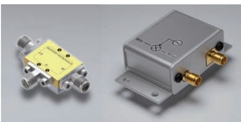
Fig. 5 - Mixer passivi a singolo o doppio bilanciamento su package con connettori alle tre porte, quasi sempre di tipo SMA. Questi componenti non di raro sono disponibili nel mercato di secondo livello, surplus o usato, a prezzi veramente convenienti.
