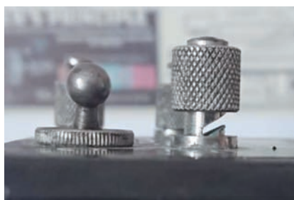
Foto 15 - Particolare del sistema di serraggio delle boccole.
