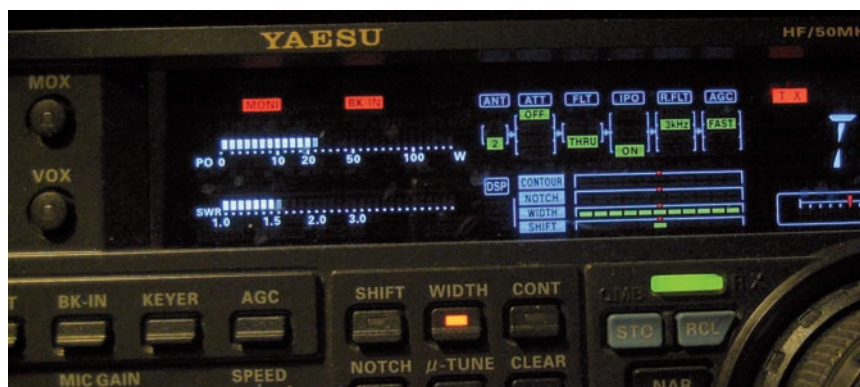
Fig. 9 - Collegando al nostro apparato un cavo a 75\Omega terminato da un carico a 75\Omega abbiamo una linea perfettamente adattata, senza stazionarie e quindi con ROS 1. Lo strumento dell'apparato segna però ROS 1.5 perché "vede" un carico a 75\Omega e non lo trova adatto alla sua elettronica che richiede 50\Omega : non gli interessa nulla delle stazionarie.
