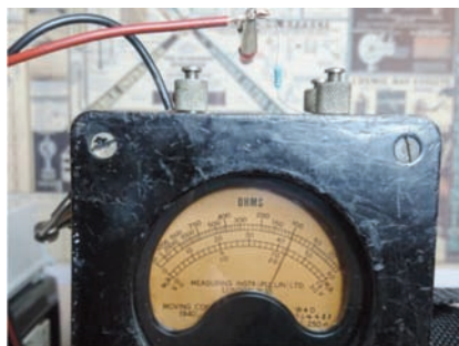
Foto 20 - Misura di un resistore da 100 \Omega , 1%, portata 5 k \Omega (indice su 100, scala 1).
