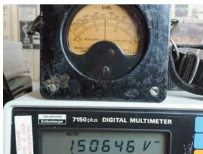
Foto 19 - Misura tensione continua, portata 3 V (indice tra 1-0 e 2-0, scala 4).
