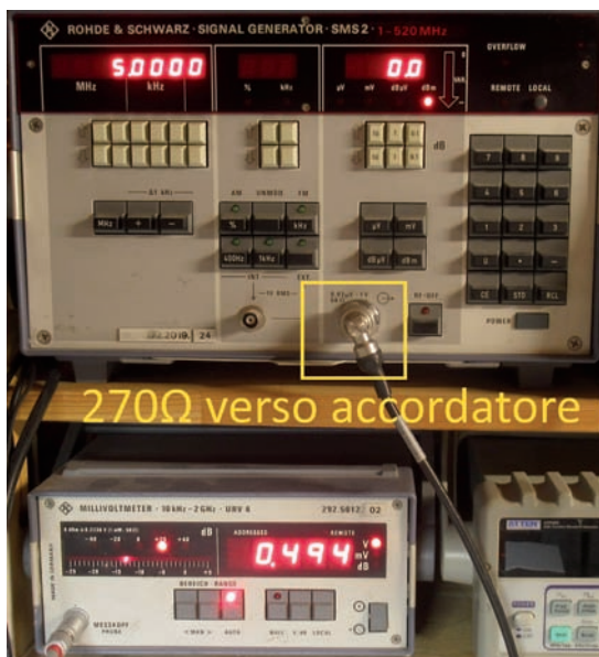
Fig. 8 - Rilevamento della tensione nelle medesime condizioni di figura 6 ma con interposti cavi coassiali e accordatore. Nonostante l'aggiunta di cavi e accordatore, la potenza è aumentata da 0.55\text{mW} a 0.90\text{mW} , passando dal 53.5% all'87.3% della potenza erogata sul carico adattato.
