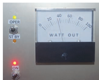
Dettagli dello strumento con l'amplificatore in funzione: 5 W input dall'817, 40 metri, CW key down.
