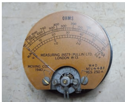
Foto 4 - Particolare delle scale dello strumento a bobina mobile.
