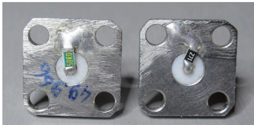
Fig. 4 - Due resistori SMD da 50\Omega e 270\Omega saldati sul retro di un connettore SMA fungono da carichi di prova.
