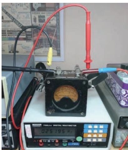
Foto 23 - Misura a 4 morsetti della resistenza interna del milliamperometro.
