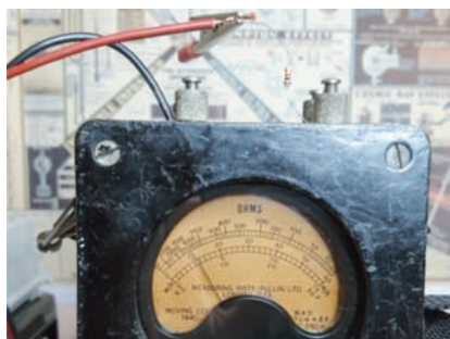
Foto 21 - Misura di un resistore da 1 k \Omega , 5%, portata 5 k \Omega (indice su 1000, scala 1)
