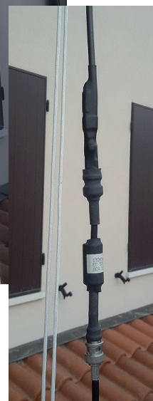
Foto 8 - Particolare della stessa antenna dotata di CHOKE in ferrite.
