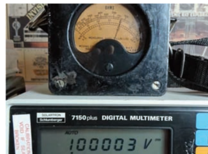
Foto 18 - Misura tensione continua, portata 1,5 V (indice su 1,0, scala 3)
