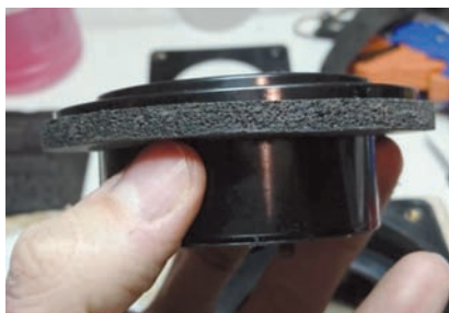
Foto 12 - Particolare di un'altra striscia di gomma che sostiene il milliamperometro.
