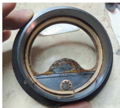
Foto 13 - Mobile di protezione del milliamperometro.
