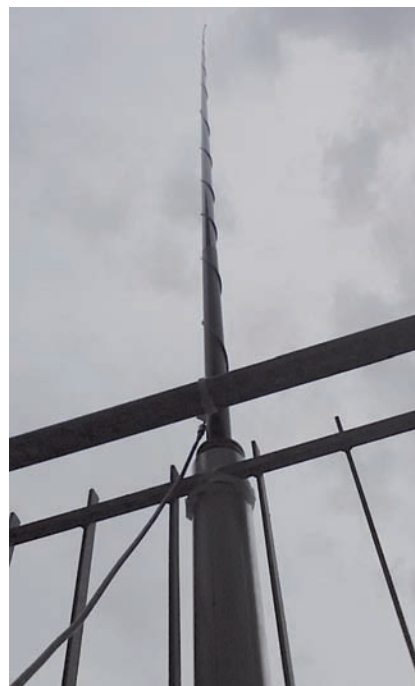
Foto 2 - Parte di LINE e RADIATORE sulla canna da pesca da 7 metri.
