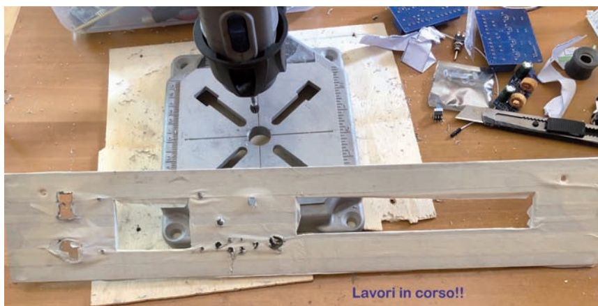
Foto 11 - Per il lavoro meccanico sono stati utilizzati semplici strumenti: trapano, dremel, frese e lima.
