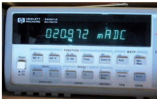
Fig. 1 - Un Arduino ATmega328p alimentato a 5V normalmente consuma circa 20-21mA.
