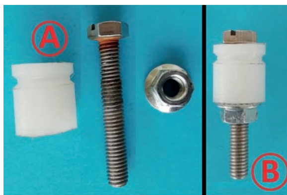
Fig. 7 - Preparazione della puleggia del motore.
