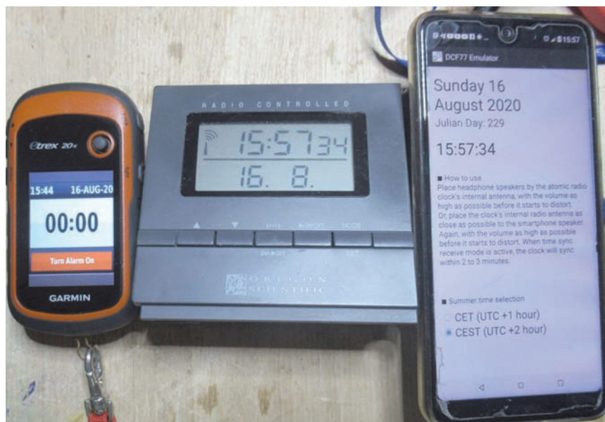
Fig. 1 - Esperimento per validare il reale funzionamento dell'applicazione. Il cellulare è stato manualmente impostato alle 15:57 mentre in realtà, come testimoniato dal GPS a sinistra, erano 14:44. Dopo un paio di minuti, la sveglia mostrava la stessa ora (sbagliata) del cellulare. L'impostazione un orario a caso diverso da quello reale rimuove il dubbio che in realtà la sveglia si possa essere sincronizzata con il vero trasmettitore DCF77.
