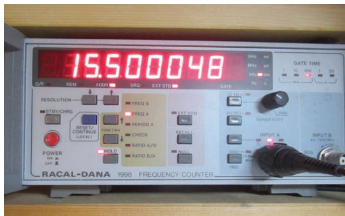
Fig. 5 - La frequenza generata dall'applicazione è esattamente 15.5kHz, la cui quinta armonica è la frequenza di 77.5kHz usata da DCF77.
