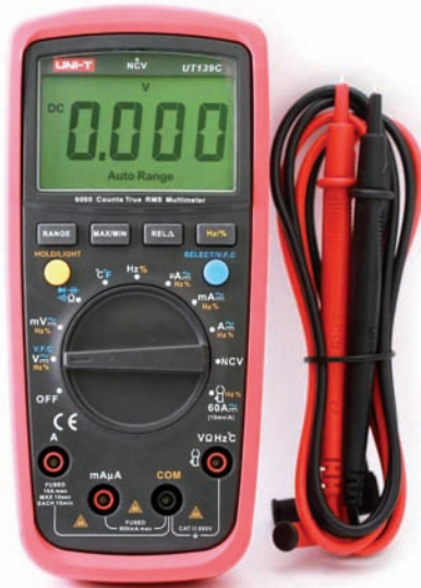
Fig. 1 - Questo è l'UT139C. La manopola per scegliere la funzione indica più funzioni nei colori giallo, bianco e azzurro. Il colore bianco indica la funzione selezionata di default; il giallo quella selezionata premendo il pulsante "Hz/%"; e l'azzurro quella selezionata premendo il pulsante azzurro. I terminali mostrati sono di CAT IV, ma quelli giunti all'autore erano di CAT II.
