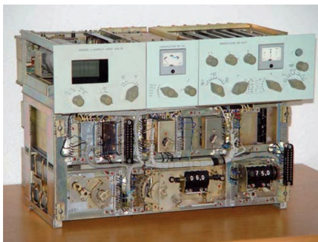
Fronte con pannello comandi smontato.
