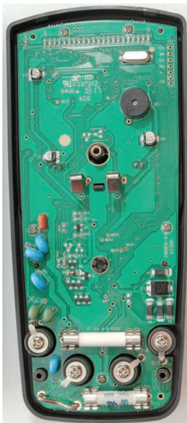
Fig. 2 - L'UT139C aperto. La qualità sembra buona. I fusibili sono ceramici, ma nel mio sono in vetro.
